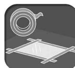
Uma outra forma de verificar se o contrapiso ou a massa regularizadora estão secos é colocando um pedaço de plástico, fixado com fita adesiva, e aguardar no mínimo 12 horas.
